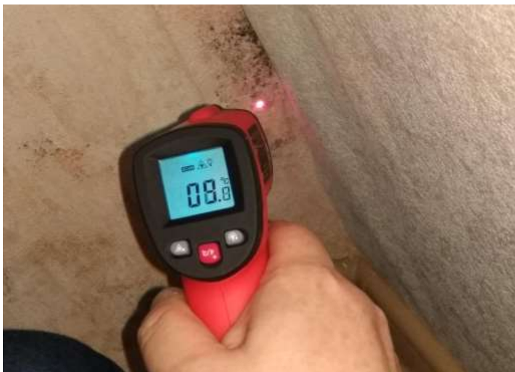
Фото 7. Измерение температуры стояка отопления в комнате-13.0 м 2
