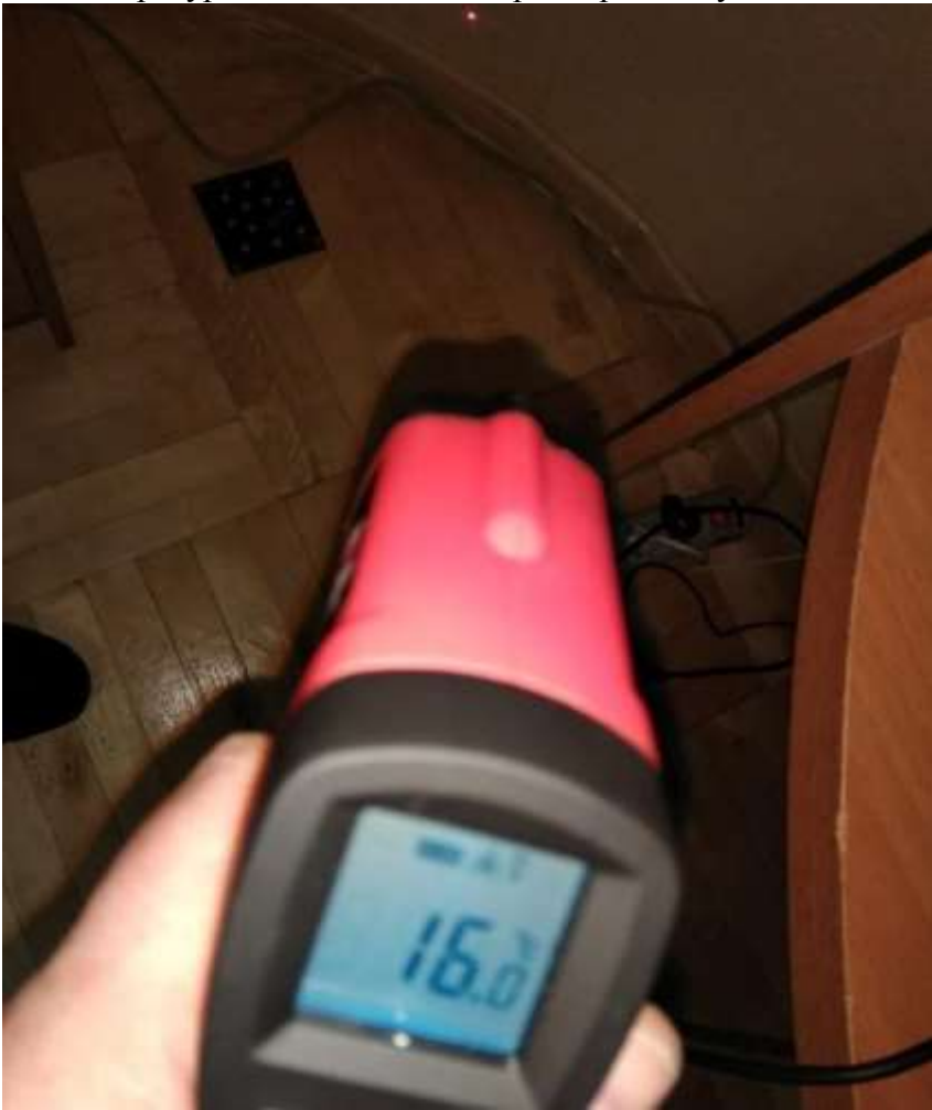
Фото 6. Измерение температуры поверхности стены в комнате 14,2 м 2
