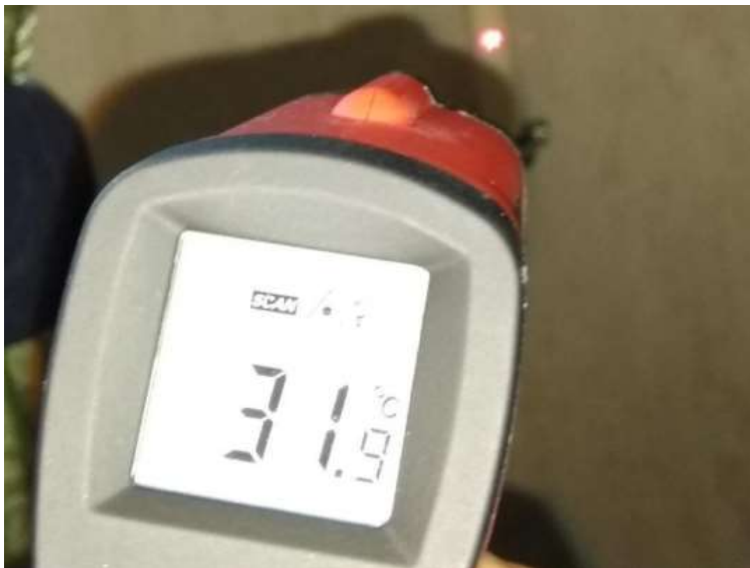
Фото 7. Измерение температуры стояка отопления в комнате-13.0 м 2
