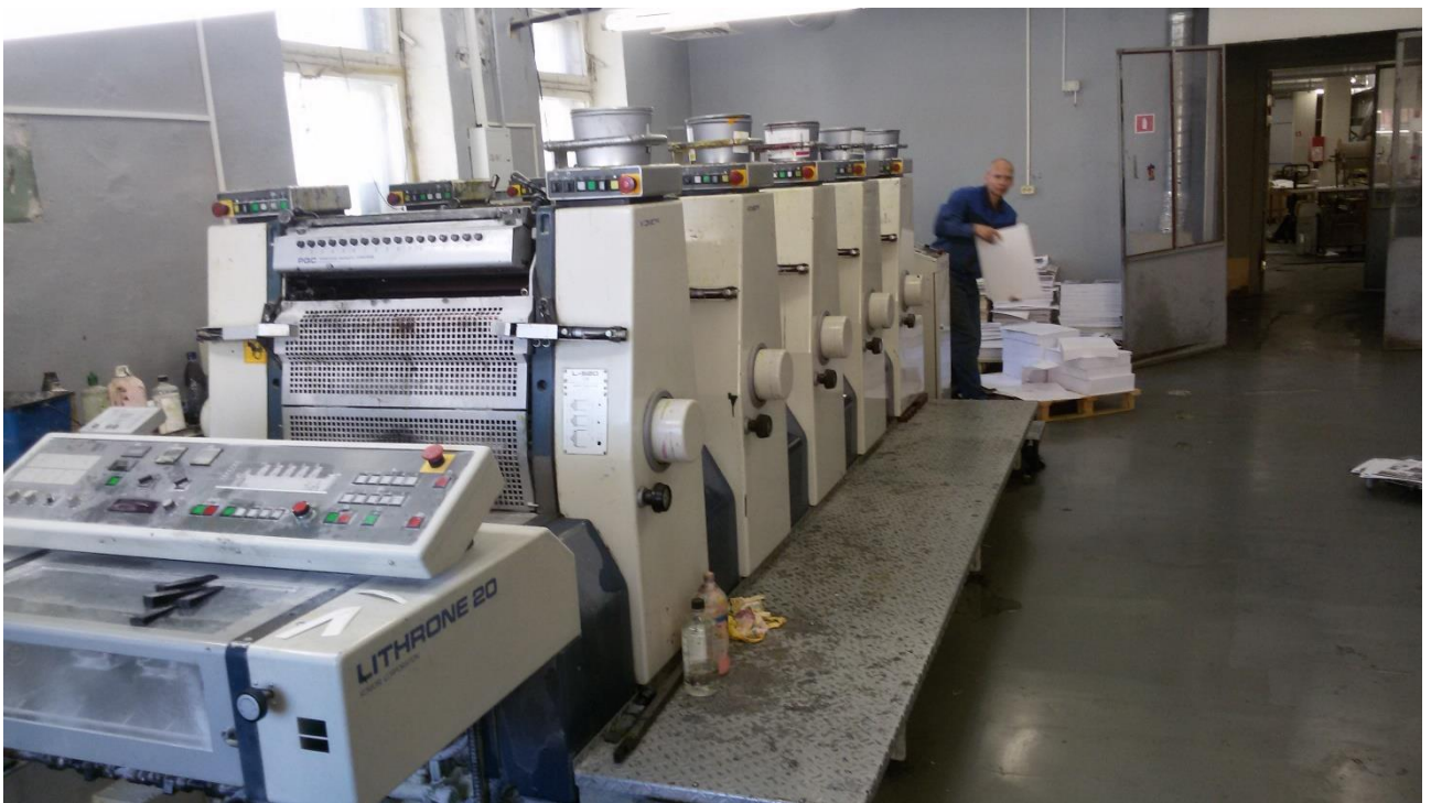
Фото П.3.2. Печатная машина на перекрытии над первым этажом
